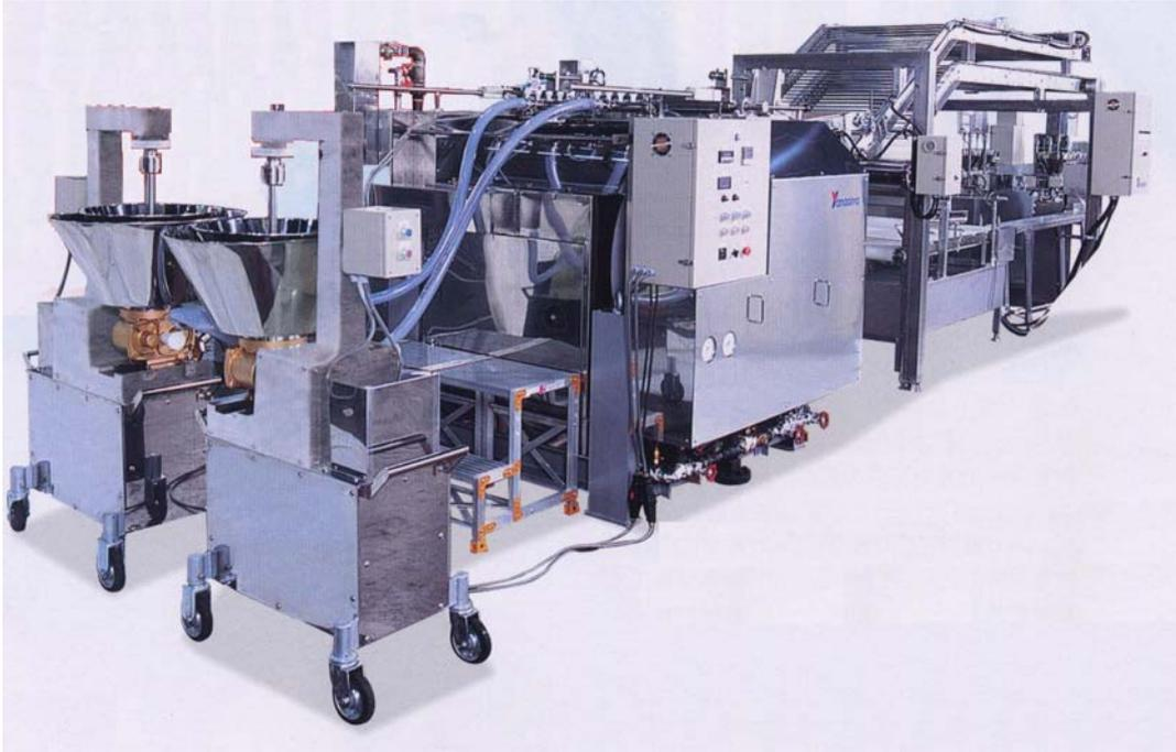
これは、カニ足かまぼこのラインを端から端まで全体が見えるように撮った写真です。左の漏斗のような所からすり身を自動的に送り出し、真ん中の四角い所のノズルから押し出してフィルム状に薄く形成し、そのフィルムを熱いドラムの上に乗せて固定化していきます。右側の部分では、薄いフィルムを製麺機みたいな機械にかけて細い繊維にし、それを集めて一本の長いカニ足かまぼこにしていくのです。その表面に色を付け、ラップでくるみ、裁断すると最終製品ができます。この辺まで人は全然要りません。大崎水産というところのご主人が開発したものですけれども、素晴らしいものだと思います。
